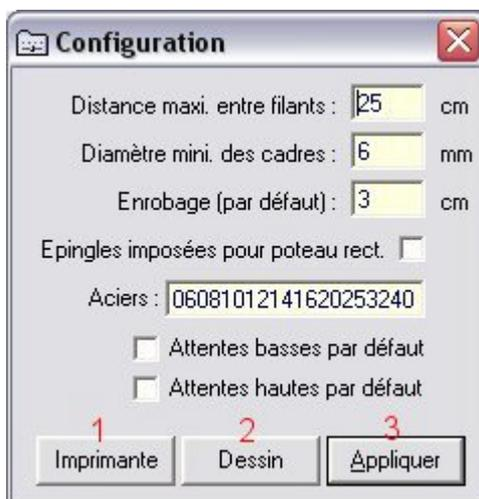
**Distance maxi. entre filants :** Lors du calcul d'un poteau, le logiciel utilise cette variable pour déterminer le nombre de barres filantes à utiliser. Le diamètre des barres sera choisi en fonction de ce paramètre. Si cette variable dépasse 40cm, elle sera automatiquement ramenée à 40cm
